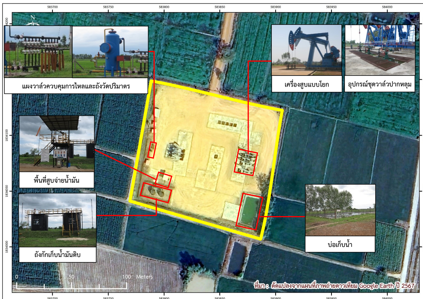
รูปที่ 1.3-5ผังการจัดวางองค์ประกอบภายในพื้นที่ฐานหลุมผลิตหนองสระ 2 (NS2)
