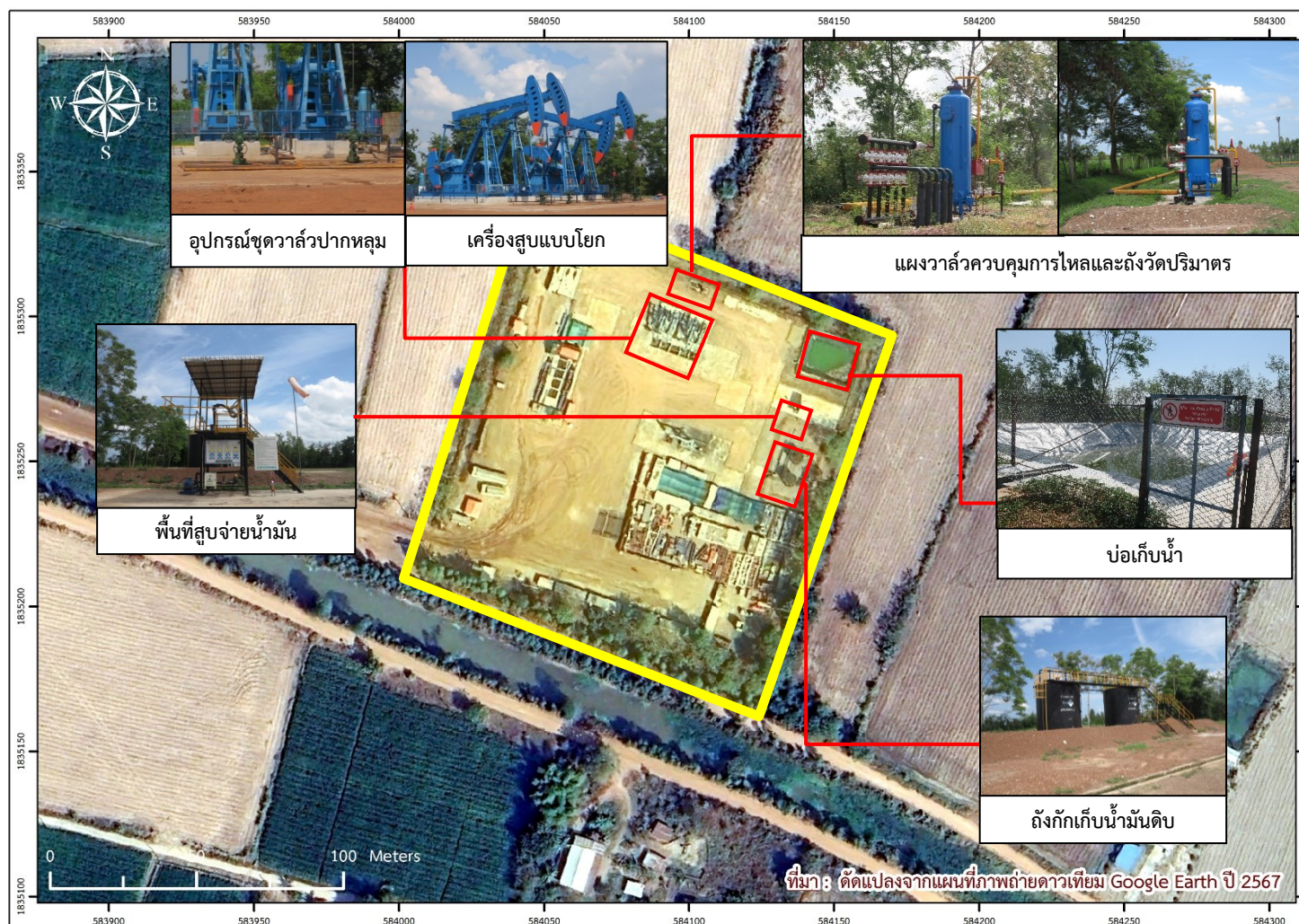
รูปที่ 1.3-6ผังการจัดวางองค์ประกอบภายในพื้นที่ฐานหลุมผลิตหนองสระ 3 (NS3)
